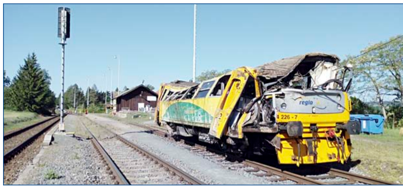
Část ujeté soupravy Regionova 814 226-7 z žst. Čisovice (DOZ Vrané nad Vltavou) a vykolejené na spádu 22 promile v Klínici byla odtažena do žst. Mníšek pod Brdy, kde byla odstavena na pátou kolej a 14. května měla být na místě rozložena.
